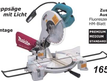
**Schnittleistung max. 93x95 mm und 69x135 mm**
